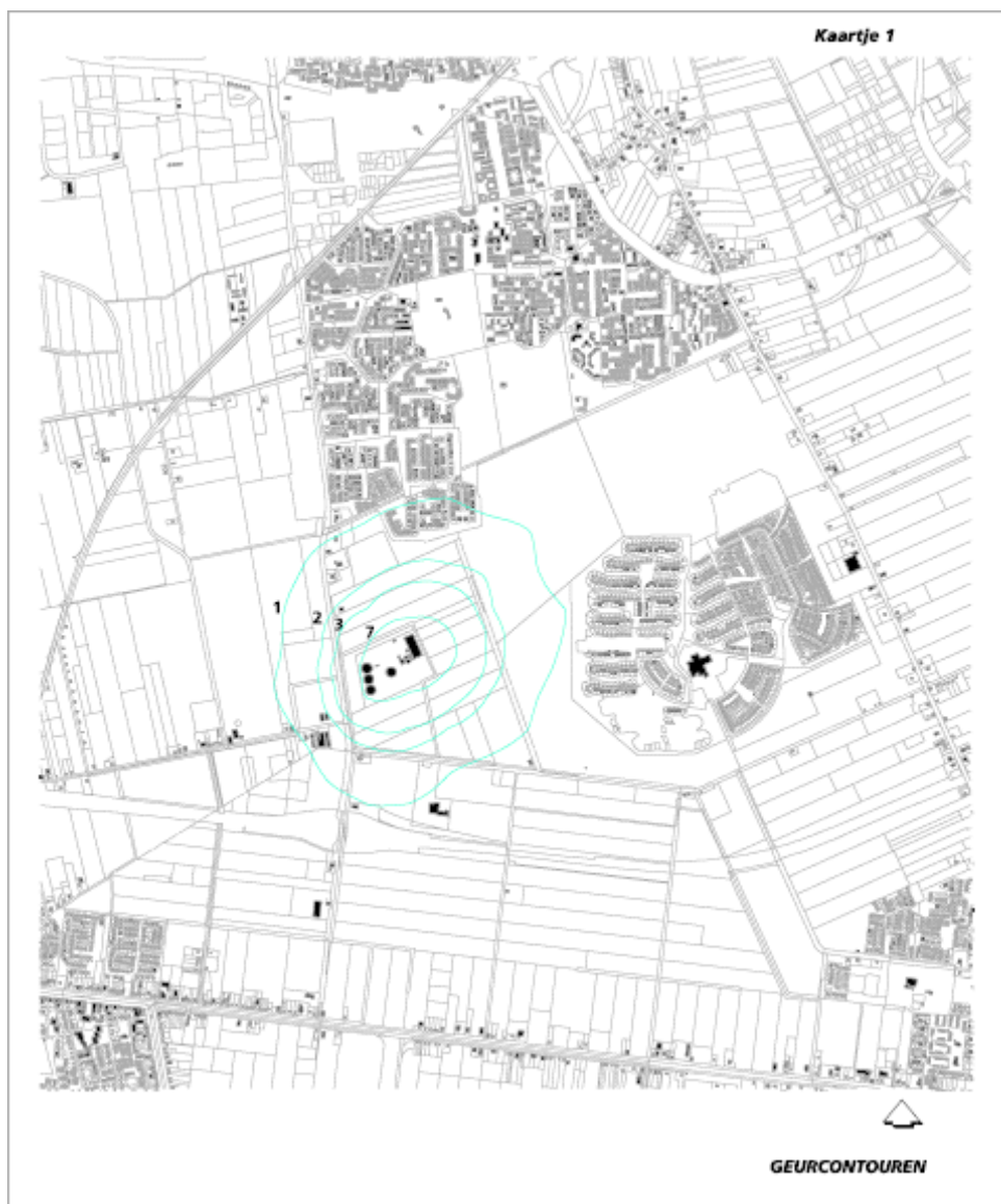
Figuur 3-4: Geurcontouren Riolwaterzuiveringsinstallatie
