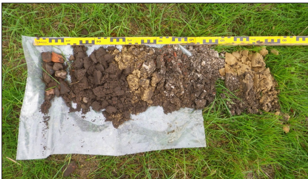
Afbeelding 12. Boring 2, met tussen 40 en 65 cm een puinhoudende laag
