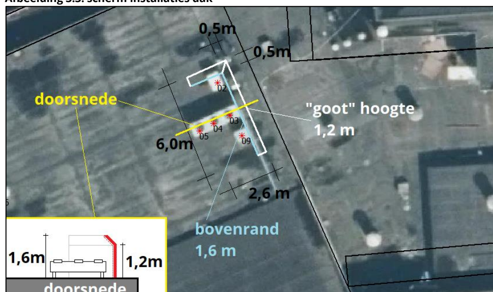
Afbeelding 3.3: scherm installaties dak
