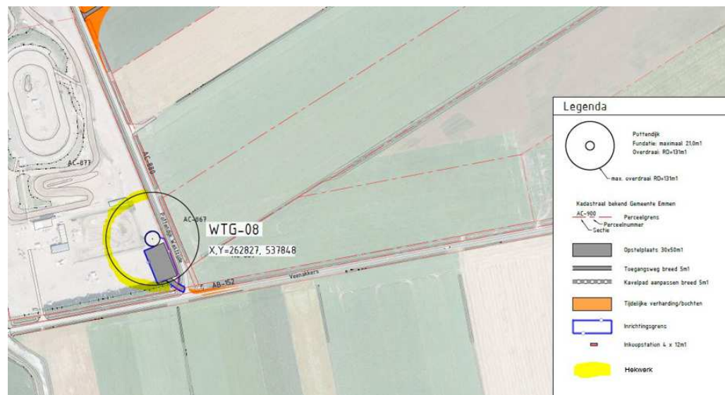
Figuur 3.4 Te realiseren hekwerk rondom 10 -5 contour windturbine op terrein Motodrome
