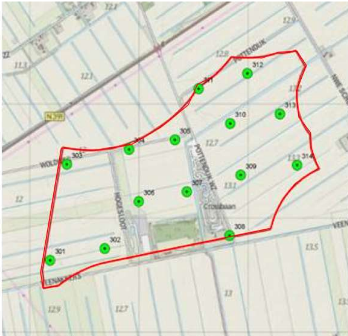
Figuur 2: De binnen het plangebied voorgenomen plaatsing van veertien windturbines 2
