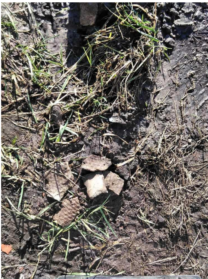
Foto 2. Asbestverdacht materiaal, Margienewijk, Nieuw-Amsterdam
