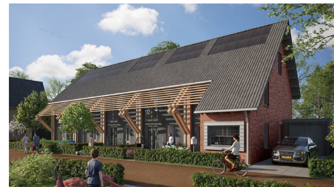
Voorbeeld van dakoverstek in de veranda zone met als materiaal hout. Ook de materialisatie achter de veranda zone heeft een andere materialisatie
