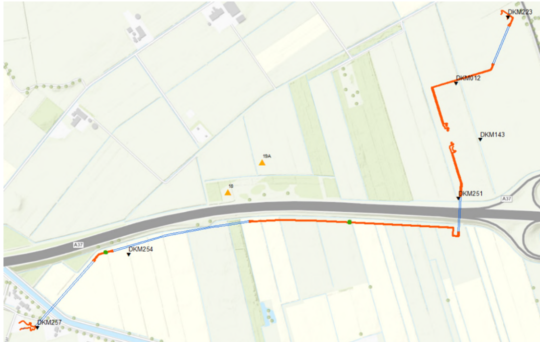
Figuur 2.3 Een overzicht van de geselecteerde sonderingen (rood is ontgravingstracé, geel is gestuurde boring met pers en ontvangstuip). In de buurt van de nieuwe masten (oranje driehoeken) zijn geen sonderingen gezet
