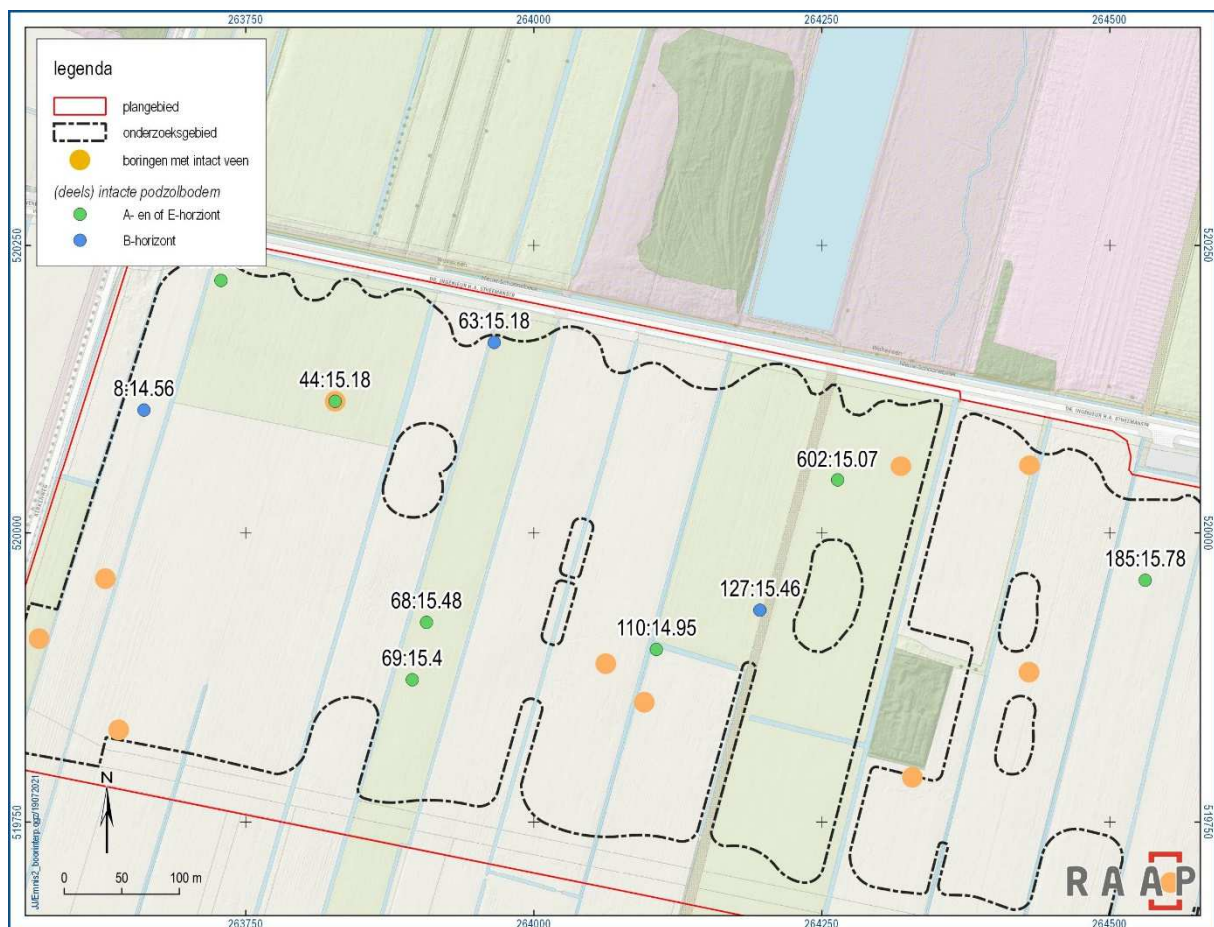
Figuur 6. Boringen met (deels) intacte podzolbodem (A-, E-, B-horizont) in het westelijke deel van het onderzoeksgebied, inclusief boornummer en diepte top dekzand in meters +NAP.
