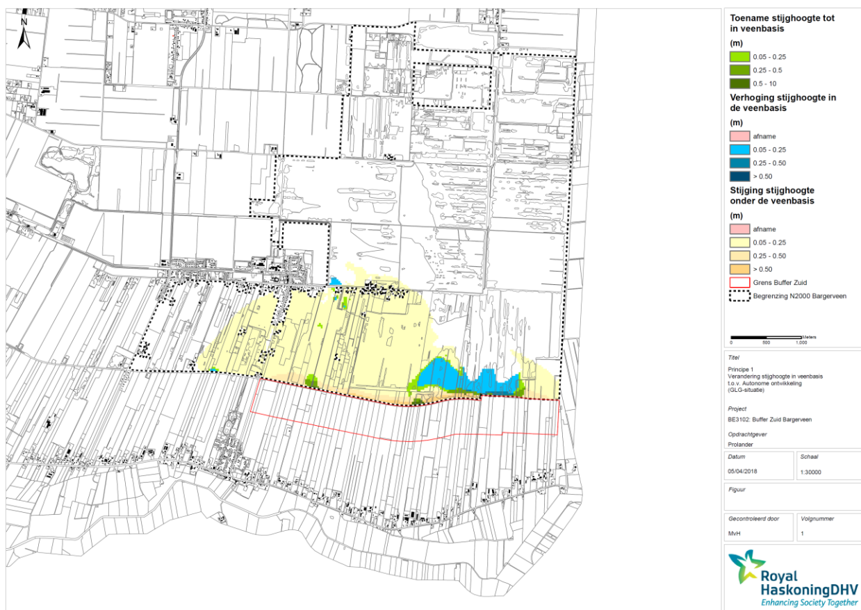
Figuur 3-3 Verandering stijghoogte ten opzichte van veenbasis Principe 1
