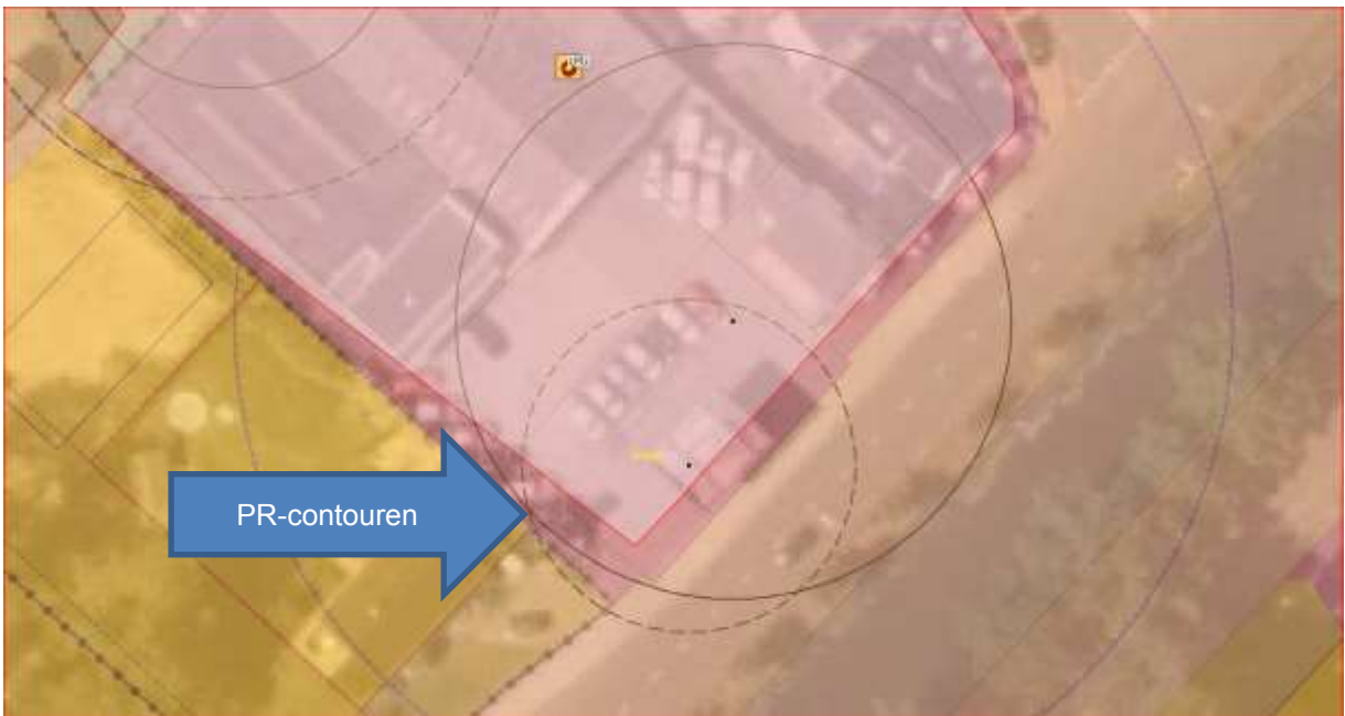
Figuur 2 PR-contouren LPG-vulpunt en –afleverinstallatie (veiligheidszone-LPG)
