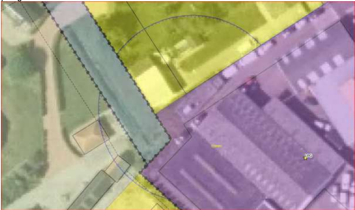
Figuur 3 PR-contouren LPG-reservoir (veiligheidszone-LPG)
