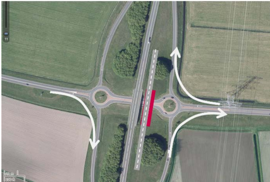
Aansluiting N381: Situering tweede viaduct en mogelijkheden voor een bypass
