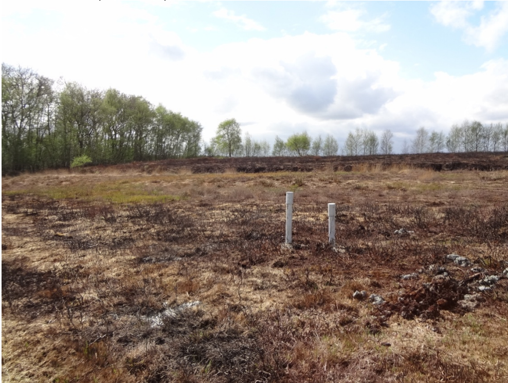
Peilbuis a01-diep en ondiep
