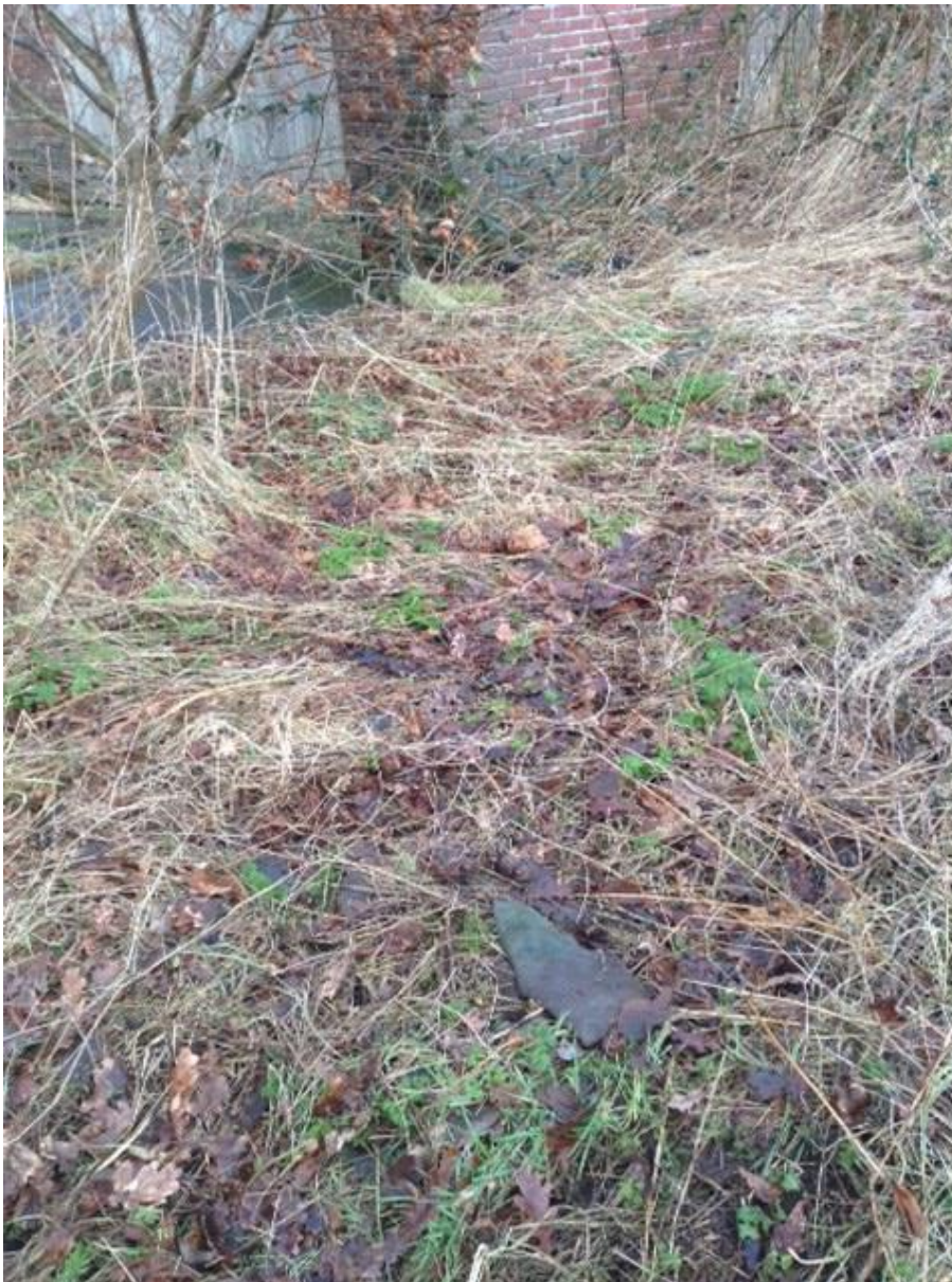
Foto 3: asbest verdacht materiaal op maaiveld
