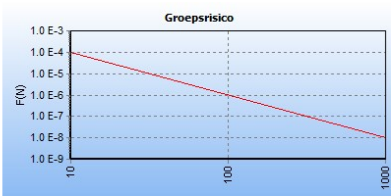
5.2 Figuur 5.4 FN curve voor N-522-62 van N.V. Nederlandse Gasunie voor de kilometer tussen stationing 8580.00 en stationing 9580.00
