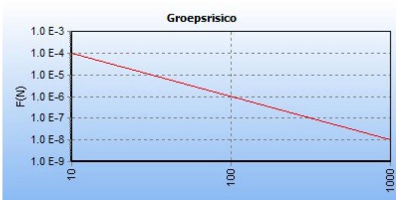
5.2 Figuur 5.4 FN curve voor N-522-62 van N.V. Nederlandse Gasunie voor de kilometer tussen stationing 8580.00 en stationing 9580.00
