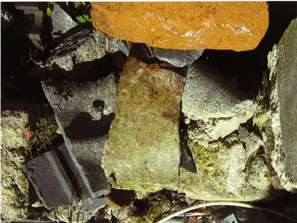
plaatje asbesthoudend materiaal
