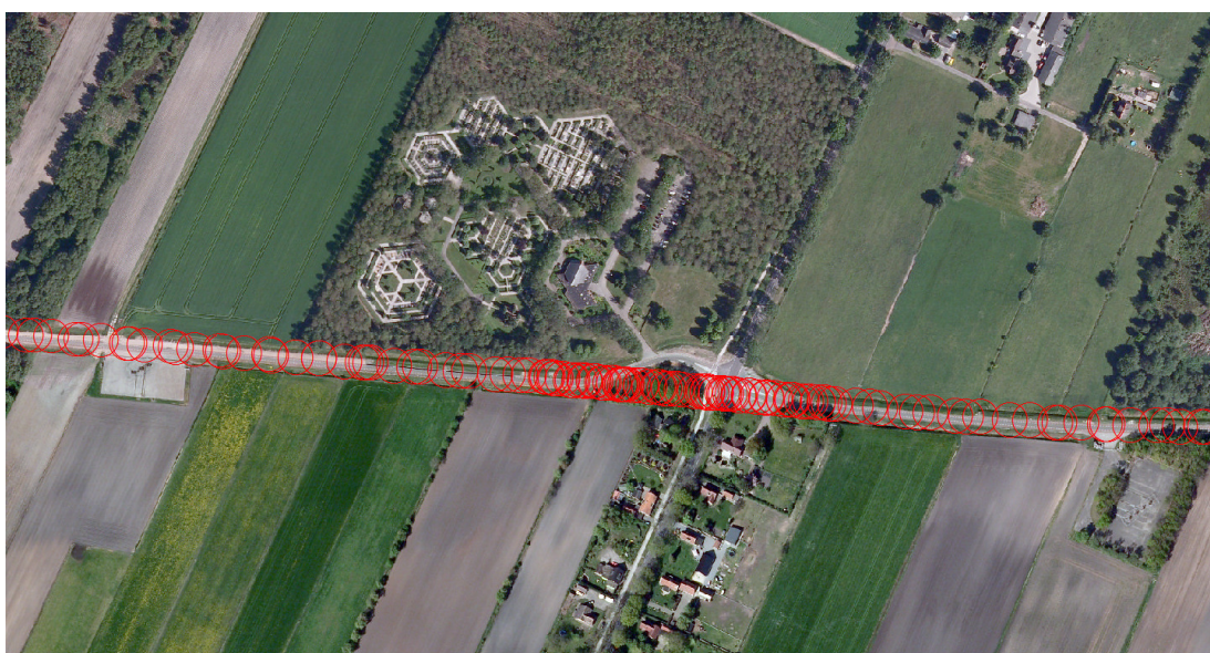
Figuur 9: plaatsgebonden risicocontour 10-6 (rood ) NAM 696 detail Ellenbeek
