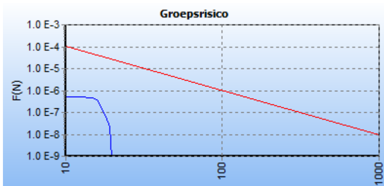
Figuur 43: fN-curve behorend bij de het groepsrisico van de hierboven gepresenteerde kilometer buisleiding
