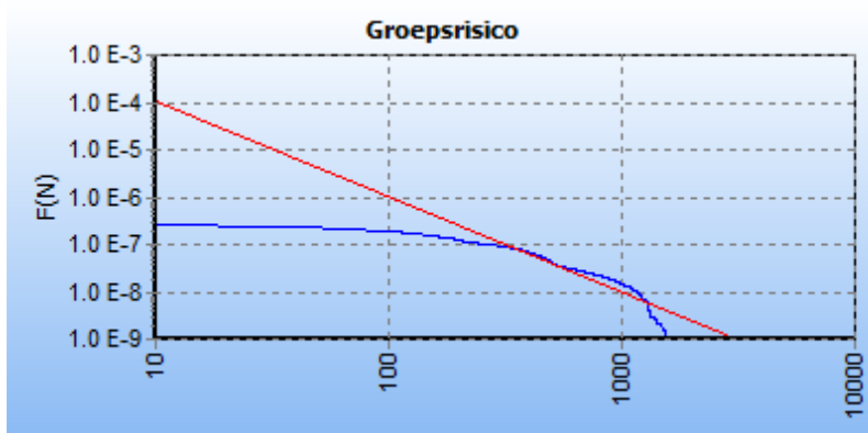
Figuur 47: fN-curve behorend bij de het groepsrisico van de hierboven gepresenteerde kilometer buisleiding
