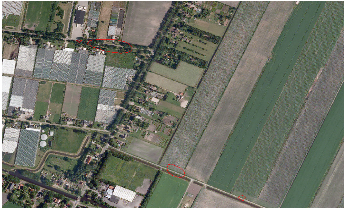
Figuur 16: PR 10 -6 contouren (rood) van de buisleiding A-582-01.
