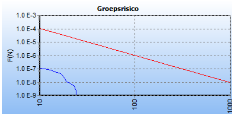
Figuur 53: fN-curve behorend bij de het groepsrisico van de hierboven gepresenteerde kilometer buisleiding
